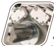
**Final de carrera: Para abrir y cerrar en forma segura.** Dos finales de carrera: uno para la fase de apertura y otro para la fase de cierre, confieren al sistema una operación segura. Además, la colocación del final de carrera aumenta la frecuencia de uso del motorreductor.
