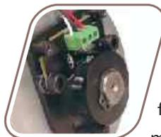
**Sistema tacométrico: Un transductor inteligente y confiable.** Una medición tacométrica, controla en forma continua la fuerza del movimiento y el frenado del motorreductor. También, actúa como sensor anti-aplastamiento, que ante un obstáculo detiene su marcha e invierte su sentido.
