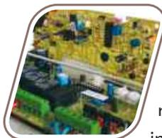
**Central de comando: La unidad de control perfecta.** Posee un sistema de frenado progresivo al término de la apertura y el cierre, imprescindible para el modelo de 8 segundos. Además alarga la vida útil del operador y elimina ruidos molestos.
