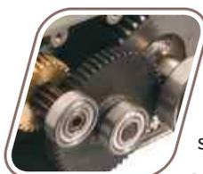
**Caja de reducción: La más fuerte y silenciosa.** Construida con engranajes de acero y bronce, montados sobre rodamientos a esferas y lubricados con grasa, hacen una caja de reducción silenciosa y de gran duración.
