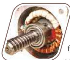
**Motor AC: Potencia por demás.** Para asegurar el movimiento en portones pesados o de uso muy frecuente, el motor eléctrico está sobredimensionado en potencia.
